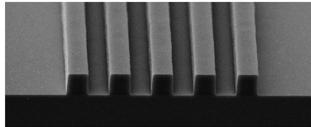
PermiNex<sup>®</sup> 1000 5  $\mu\text{m}$  thick coating
